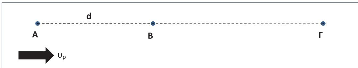
Έστω Α το πρώτο σημείο συνάντησης με τη σχεδία τη χρονική στιγμή  $t = 0$ , Γ το σημείο στο οποίο η βενζινάκατος γυρίζει πίσω τη χρονική στιγμή  $t_1 = 1 \text{ h}$  και Β το δεύτερο σημείο συνάντησης, τη χρονική στιγμή  $t_2$ . Η σχεδία επομένως καλύπτει την απόσταση AB σε χρόνο  $t_2$  με ταχύτητα  $u_\rho$ , η βενζινάκατος την απόσταση ΑΓ σε χρόνο  $t_1 = 1 \text{ h}$  με ταχύτητα  $u_\beta + u_\rho$  και την απόσταση ΓΒ σε χρόνο  $t_2 - t_1$  με ταχύτητα  $u_\beta - u_\rho$ .
